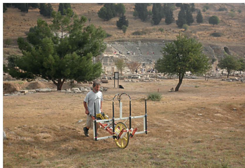
S. Seren (ZAMG) mit einem Förster FEREX Fluxgate 4-Sonden Magnetometer, Obere Agora 2012 (© ArcheoProspections@ ZAMG)
